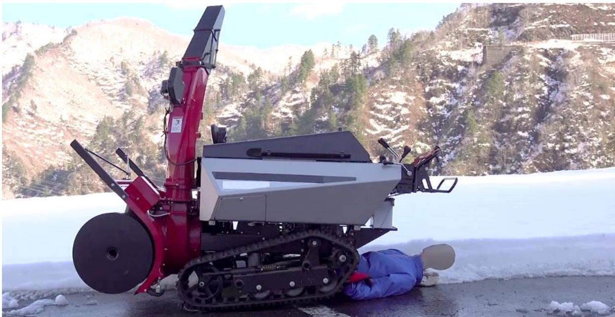
誤った使用で除雪機の下敷きになった事故（再現映像）
